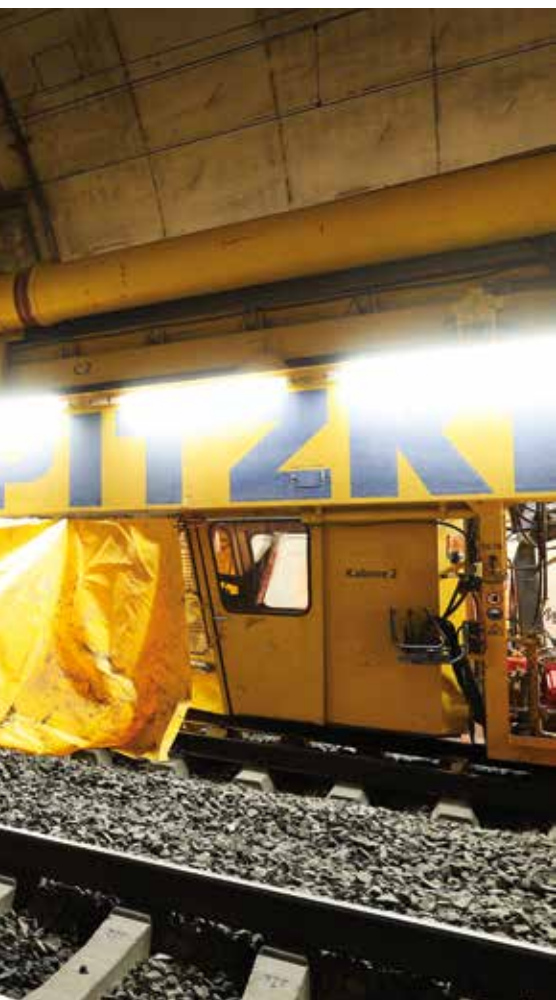
Der Siebwagen der RM 900 S mit Einhausung und Absaugung
