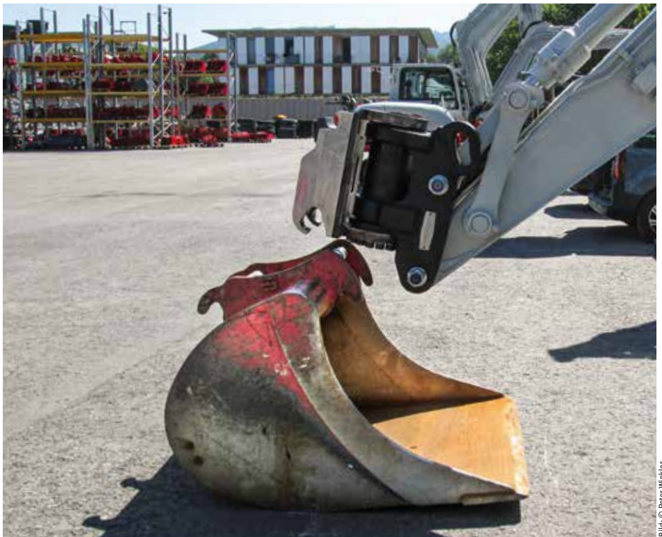
Mechanische Sicherung an der Aufnahmeachse durch Ausformung der Klaue
