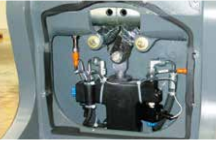
Sensorik zur Erfassung der korrekten Bolzenstellung und Lage des Anbaugeräts
