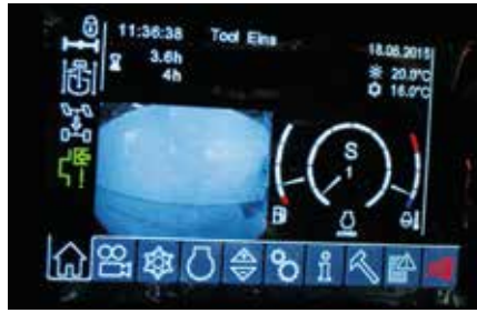
Optische (und akustische) Anzeige einer falschen Verriegelungsposition
