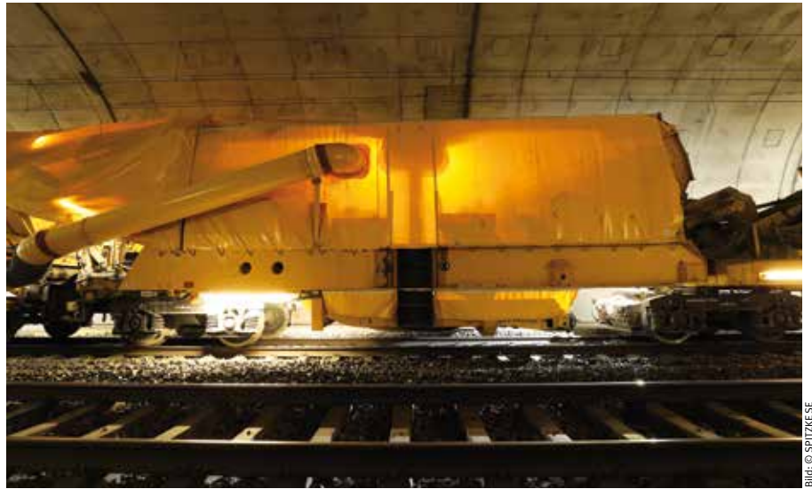
Der Siebwagen der RM 900 S mit Einhausung und Absaugung
